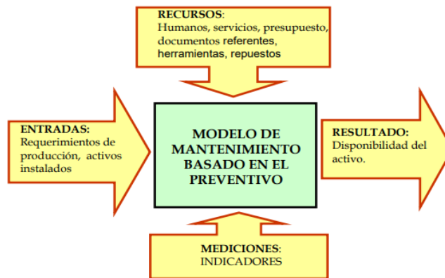
Ilustración 5: Entradas y Salidas del mantenimiento preventivo
